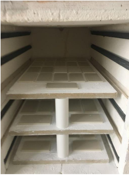
Şekil 4: Seramik fırınında 1220°C pişen bünye denemeleri
